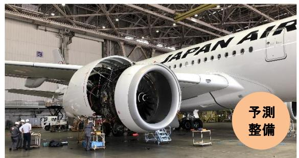
航空機エンジン内部には何百枚ものタービンブレード（※1）が存在しており、工業用内視鏡を使用して検査を行っていますが、ブレード1つ1つの故障リスクを見分けるには整備士としての長年の経験とそれに基づく技術が求められます。
